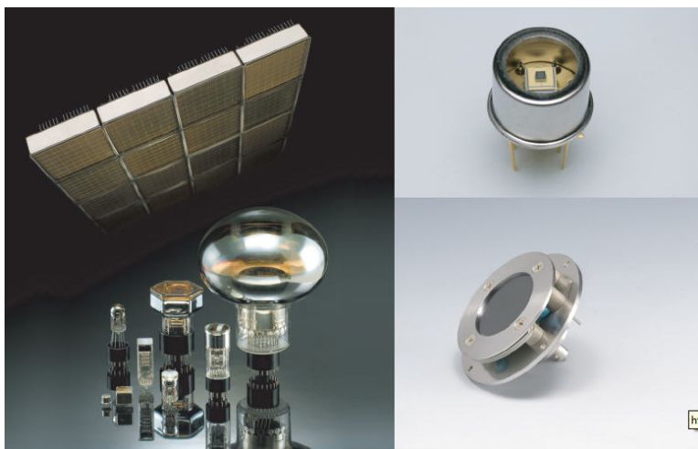
Slika 17 Detektori koji omogućavaju prebrojavanje fotona: fotomultiplikatorske cevi (levo), lavinska fotodioda (desno gore, oko 1 cm) i višekanalna ploča (desno dole, oko 10 cm) (© Hamamatsu Photonics).
