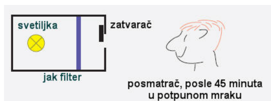
Slika 14 Kako doživeti efekt pojedinačnih fotona (vidi tekst)
