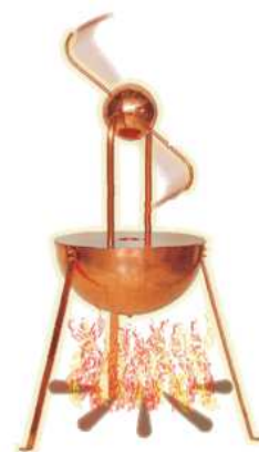
L'éolipyle, la turbine à vapeur de Héron d'Alexandrie
