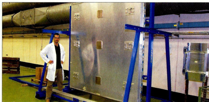
Les chambres à tubes à dérive espagnoles, fabriquées pour le détecteur de muons (partie tonneau) de CMS, sont testées puis stockées au CERN.
